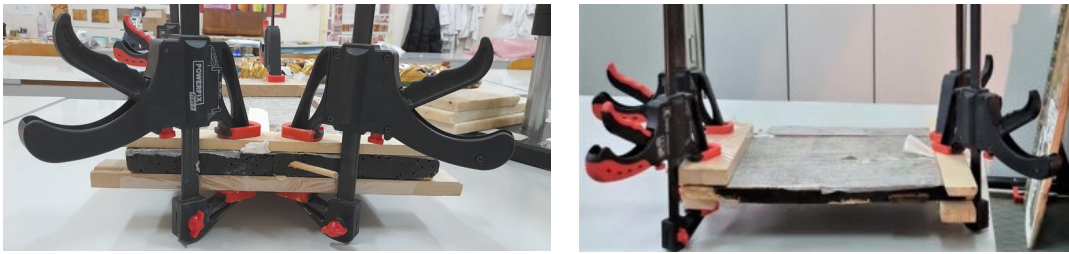
Fig. 9. Lipirea scândurilor și fixarea lor cu cepul (cantul inferior și vedere laterală)
