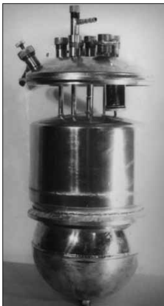
Senzorul de radiație infraroșu „Bolometru supraconductiv neizotermic”, elaborarea savantului A. Sidorenko (Patent A. Sidorenko № 224928, 02.09.1985, Sistem de monitorizare globală). A fost utilizat în stația spațială „MIR” în scopul cartografiei suprafeței pământului și explorării zăcămintelor subterane pe parcursul a 5 ani (1987– 1991), fără întrerupere.
