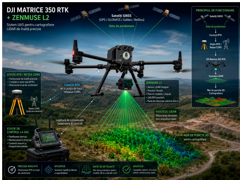
Fig. 1. Ansamblul UAS și principiul de colectare cu precizie înaltă a datelor.
