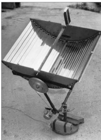
Mostra captatorului solar de producere combinată a energiei electrice și termice sub formă de apă caldă, elaborată în Laboratorul de surse netradiționale de energie al Institutului de Energetică al AȘM. Muzeul Științei al AȘM. Fond foto. Cota arhivistică: 00204.
